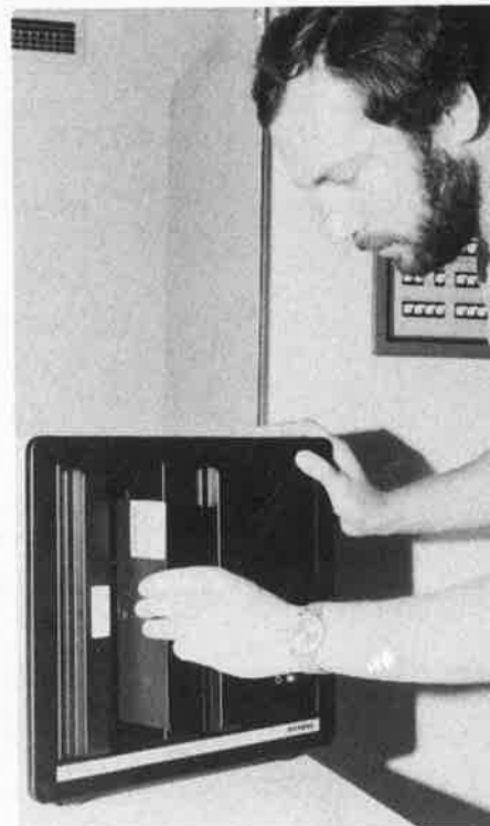
Figure 1. On voit ici comment une disquette est introduite dans l'unité. L'étiquette est toujours du côté de la porte.
